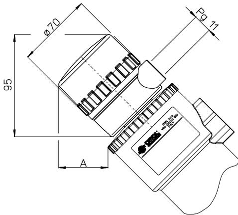
Датчик положения предназначен для контроля открытия и закрытия клапана. Доступен для подключения с приводом DN50, DN63, DN90, DN110.
