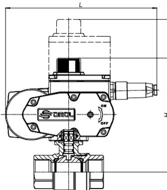
С электрическим приводом Откр./Закр.
